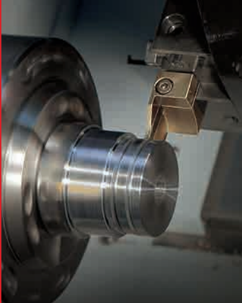
Werkzeuge und Schneideinsätze zum Ein- und Abstechen
