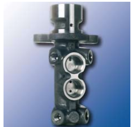
Факторы безопасности: сверление и развертывание в главном тормозном цилиндре
