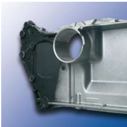
Комплексная обработка: кронштейн двигателя в круглотактовом станке
