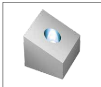
Сверление на наклонной поверхности
