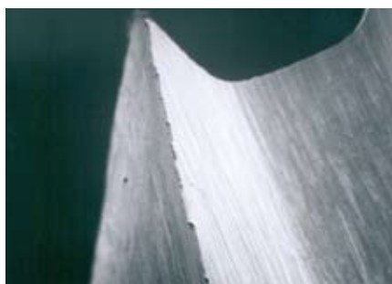
Зуб обычного бесстружечного метчика
