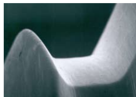
Оптимизированная поверхность бесстружечного метчика Profile фирмы Gühring
