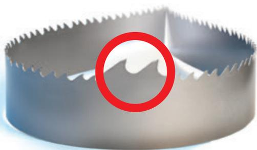
Универсальные твердосплавные пилы TRI-MASTER обеспечивают отличное качество обрабатываемой поверхности, а так же исключительную стойкость режущей кромки при использовании в литейном производстве. Зубья, сделанные из твердого сплава с ультрамелкозернистой структурой (менее 1 мкм), специально разработаны для резания алюминиевых сплавов и цветных металлов. Высокоточное шлифование предотвращает налипание материала на режущую кромку.
