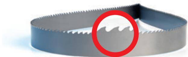
Ленточные пилы TNT CT имеют максимально возможный для твердосплавных пил угол заточки и трёхстружечную форму зуба. Пила предназначена для резания сплошных заготовок из следующих материалов: титановые и никелевые сплавы, нержавеющие и инструментальные стали, алюминиевые сплавы. Высокая стойкость пилы обеспечивается за счет нового износостойкого материала режущей кромки и специальной стали полотна основы пилы.
