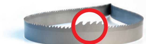
Ленточные пилы HRc предназначены для резания упрочненных материалов, поверхностно закаленных заготовок, специальных бронзовых сплавов. Исключительная стойкость пилы обусловлена высококачественным мелкозернистым твердым сплавом, нулевым углом заточки, устойчивой к выкрашиванию формой зуба.
