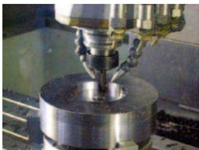
Цельная твердосплавная фреза Ф10 мм, z=4, сталь 34CrNiMo6 (30 HRC), обдув воздухом, минимум СОЖ – Тестируемый инструмент: 2x4
