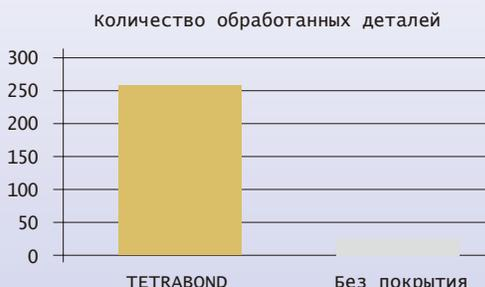
Инструмент с покрытием TETRABOND показал стойкость в 8 раз большую, по сравнению с инструментом без покрытия.
