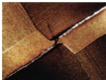
Обычное покрытие для высокоскоростной обработки
