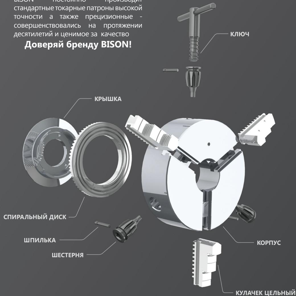
Наши патроны делаются из кованной стали или чугуна; все рабочие поверхности индукционно закалены и обработаны так, что готовый продукт представляет собой надежный патрон, который отвечает Вашим высоким требованиям, имеет стабильность и долговечность параметров, а также наиболее эффективный на рынке фактор: цена/качество.
