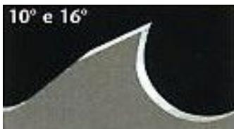
Ленточные пилы **REZON bi-alfa Master** и **RP Master** имеют специальную разводку и заточку шлифованных зубьев, обеспечивающих равномерное распределение нагрузок в процессе резания. Наличие на центральных зубьях боковых фасок способствует лучшей устойчивости пилы и снижению уводки, а менее нагруженные боковые зубья обеспечивают лучшую шероховатость и чистоту обработанной поверхности. Рекомендуются для резки
