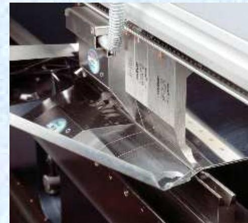
Система анти-прогиба представляет собой два клина, расположенные напротив друг друга. Усилие прикладывается ко всей поверхности подштамповой плиты, за счет чего корректируется прогиб рамы и стола. В зависимости от расчетной нагрузки система срабатывает с точностью 0,00039”.
