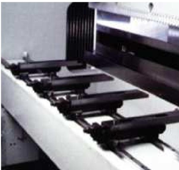
Задний упор типа DC 320 (X-R оси)
